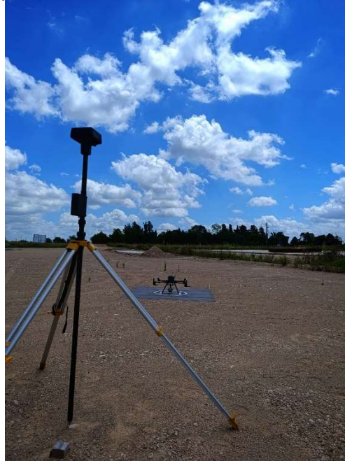
Base RTK – Drone – punto de control
