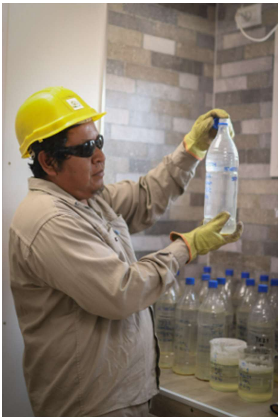
Imagen 12. Operario separando muestras del agua de formación
