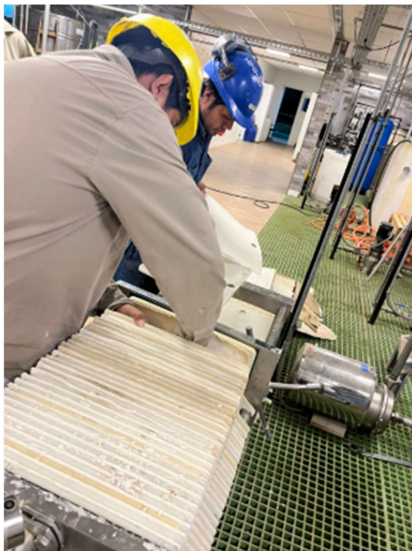
Imagen 22. Ajustes del Filtro Prensa (para extracción de carbonato de litio)
