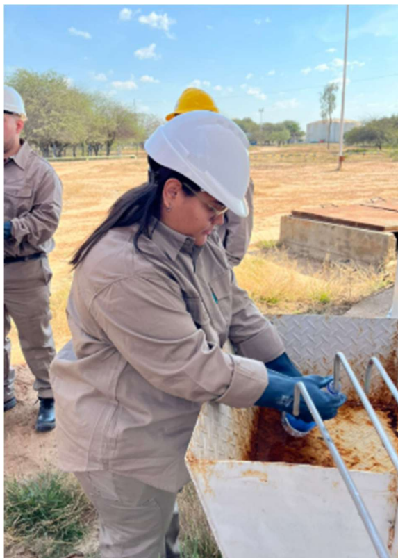
Imagen 15. Toma de muestras a la salida del Tanque 21 - de 1000m3
