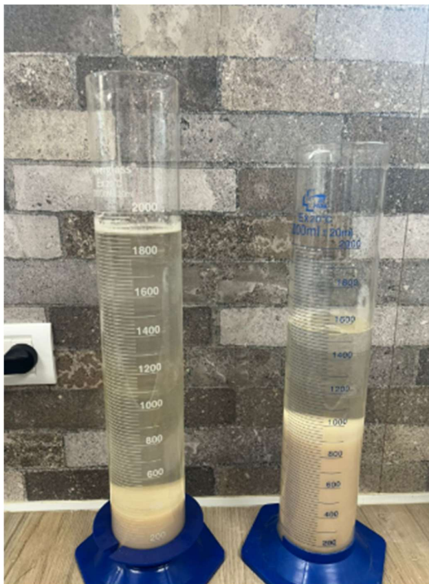
Imagen 4. Preparación de agua litiada en laboratorio (decantación de sólidos)
