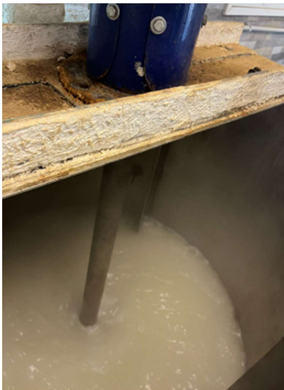
Imagen 21. Concentración de Cloruro de Litio - previa carbonatación
