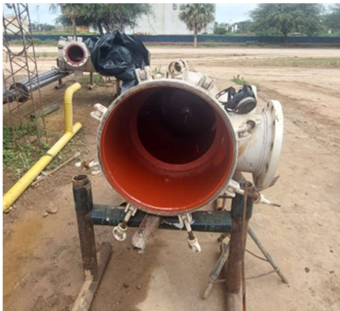
Imagen 17. Carcasa con aplicación de antióxido
