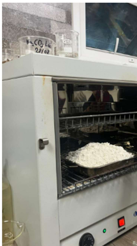
Imagen 10. Secado del carbonato de litio en estufa de laboratorio
