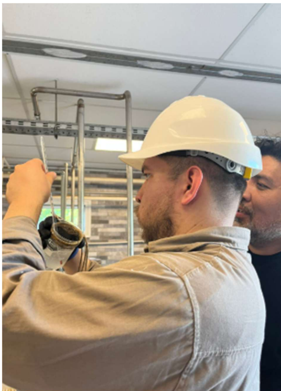
Imagen 20. Medición de temperatura en concentrado de litio - previo a carbonatación
