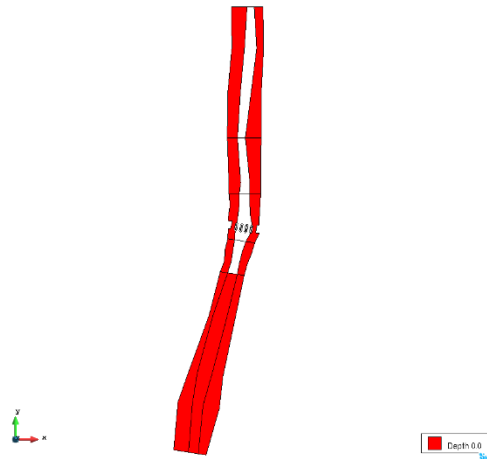
Figura No. 16. Se definieron regiones del dominio no erosionables (en rojo) y susceptibles de erosión (en blanco).
