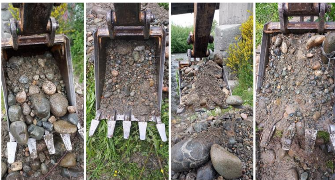
Figura No. 3. Material extraído de la exploración del subálveo donde se observa la presencia de clastos de gran tamaño (referencia de escala: el balde tiene un ancho de 0.45 m).
