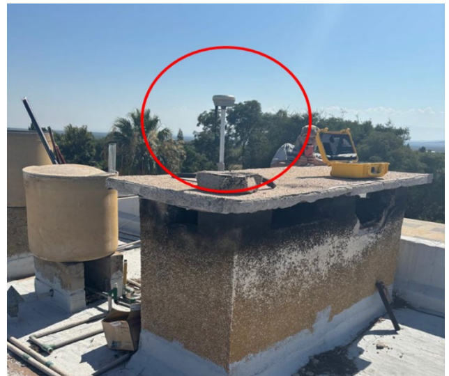
Imagen N° 17: Base GNSS transmitiendo de forma permanente desde la terraza del hotel ACA (ver Anexo 3)
