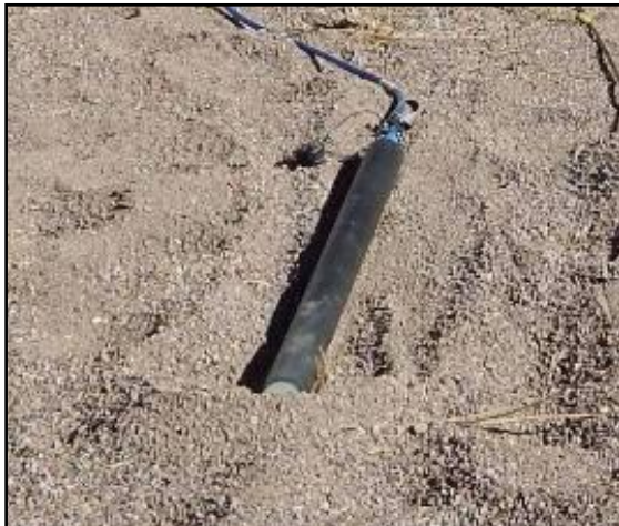
Figura 15. Bobina del magnetómetro de inducción marca Lemi modelos 118 o 120
