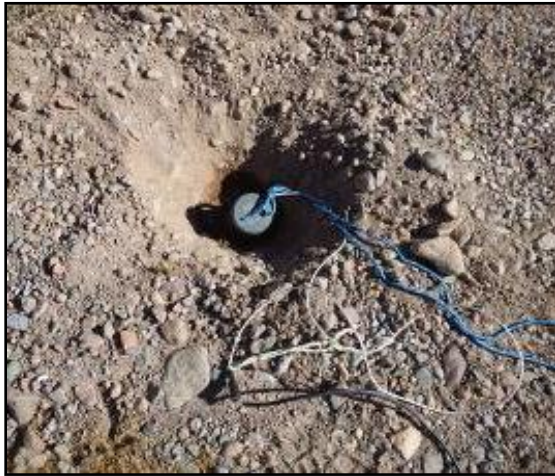
Figura 14. Electrodo impolarizable marca Lemi modelo 701
