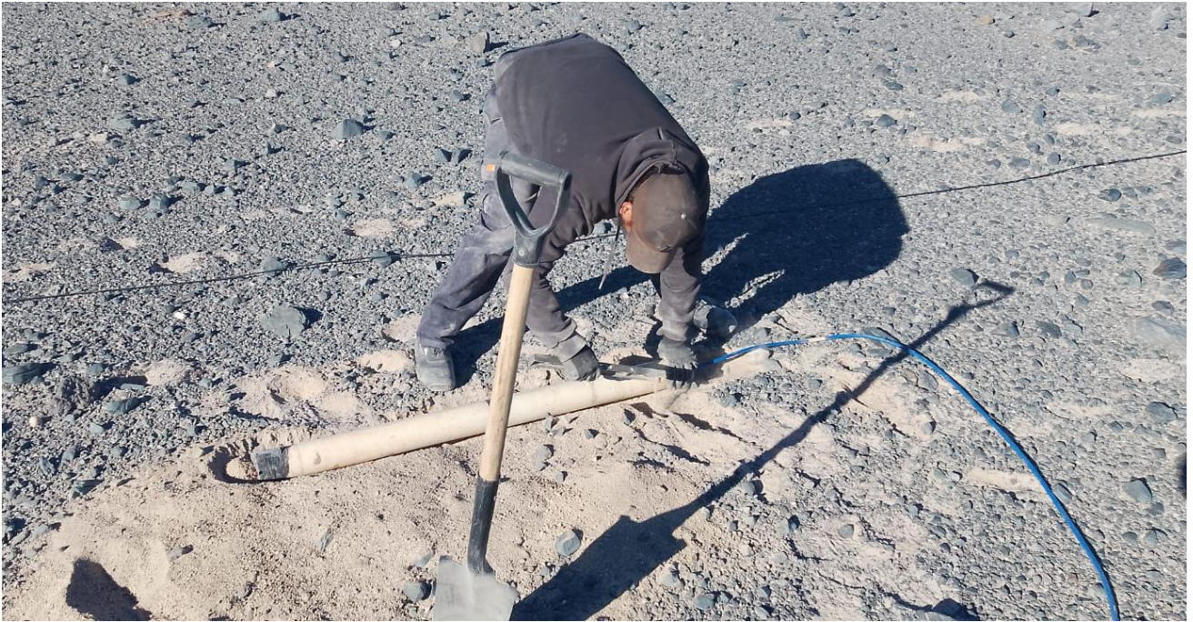
Figura 18. Conexión de sensores, sensor magnético LEMI-120.
