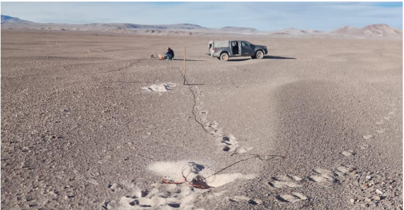
Figura 19. Conexión de sensores, sensor electrodo impolarizable LEMI-701
