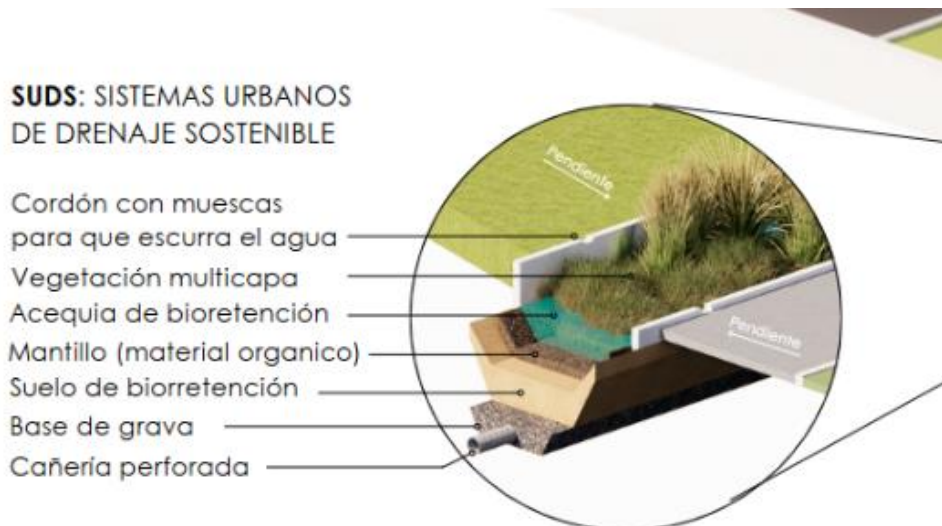
Figura 41. Sistema urbano de drenaje sostenible (SUDS) propuesto para corredores urbanos. Esquema conceptual de funcionamiento. Fuente: Elaboración propia.
