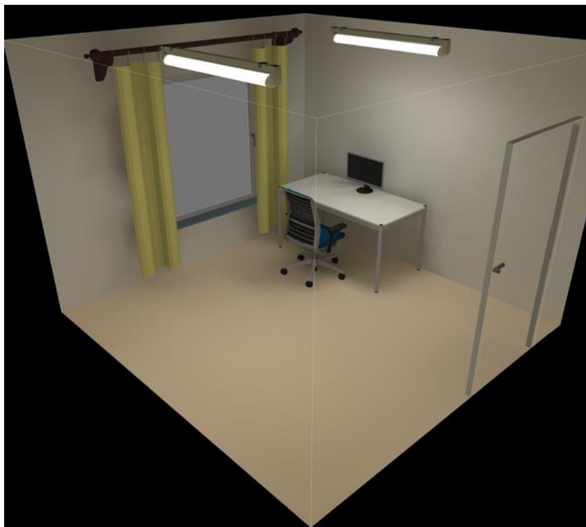
Figura 166: Modelado de iluminación oficina con recambio de luminarias -Chimpay
