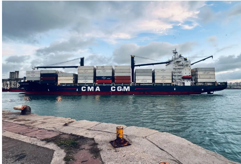
Figura 9: Buque portacontenedores de la naviera CMA CGM en Puerto de Mar del Plata - Eslora: 170 m, Manga: 27m, Calado mínimo 8,80m.
