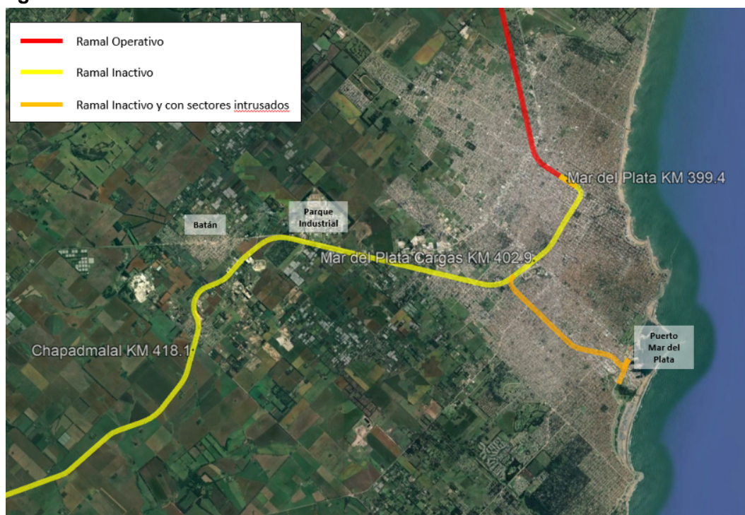
Figura 32: Red Ferroviaria. Estado de los ramales en la zona de Mar del Plata.
