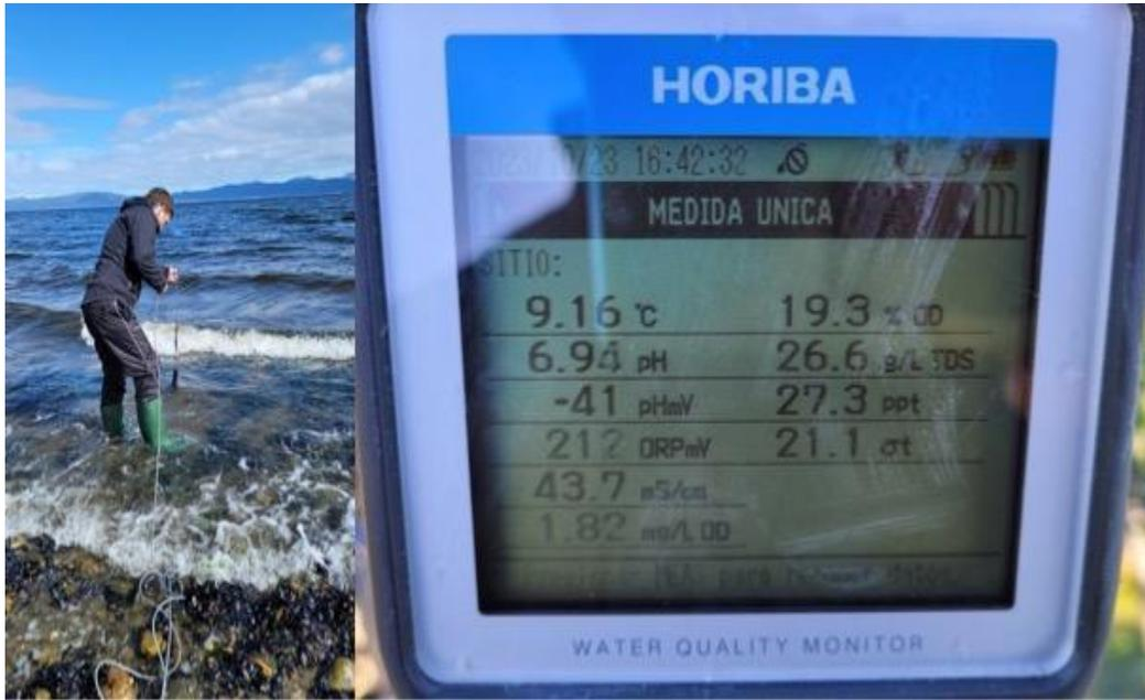
Figura 19. Relevamiento de parámetros ambientales en agua superficial costera con la sonda multiparamétrica Horiba.
