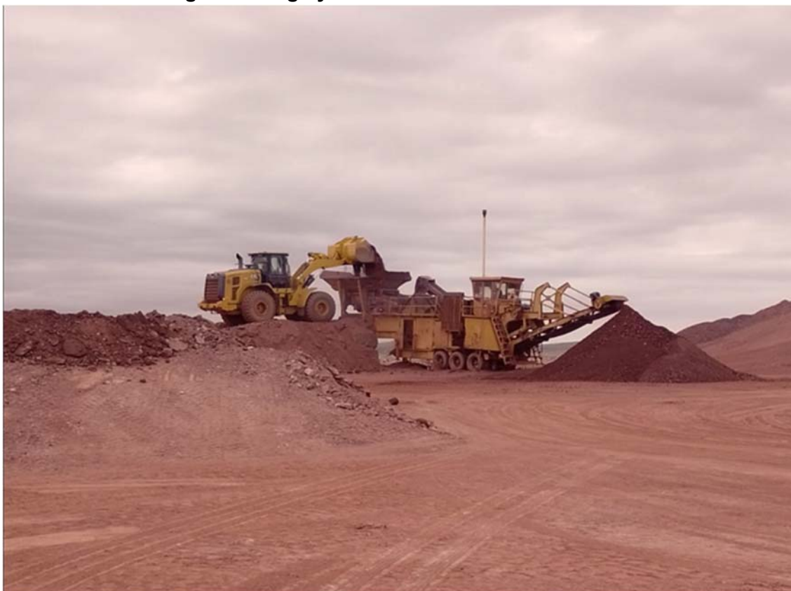
Imagen 5. Carga y trituración de arcillas en Barker
