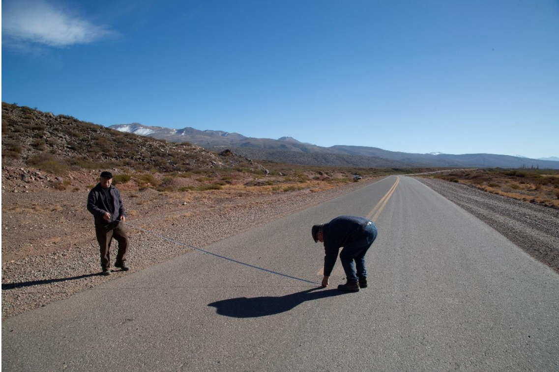
Fotografía 34 – Progresiva 45+800 – Inicio del Pavimento – Midiendo el ancho de calzada – ac= 6.70 m
