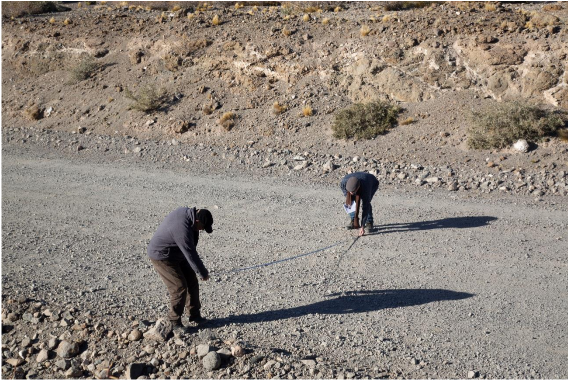
Fotografía 3. Progresiva 0+000 Inicio de la Sección 1 – Midiendo el ancho de calzada
