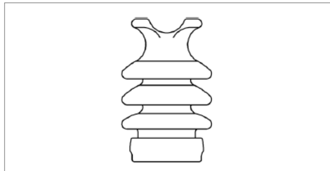
Figura Nº 8: Esquema del modelo de aislador line post elegido.
