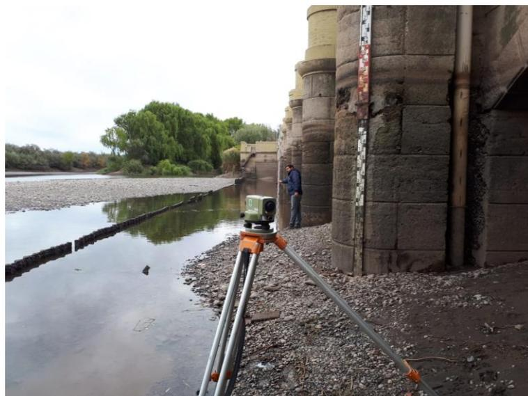
**Foto N° 18: Regla Graduada y conducto para limnógrafo.**
