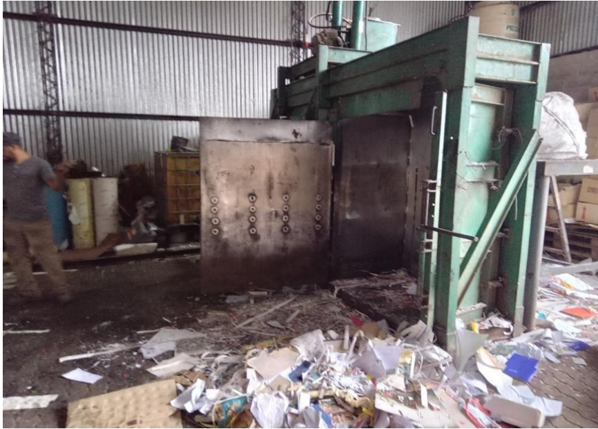
Figura 2.7: Vista lateral de la prensa y enfardadora Contenedores Diego. Fuente: Elaboración propia.
