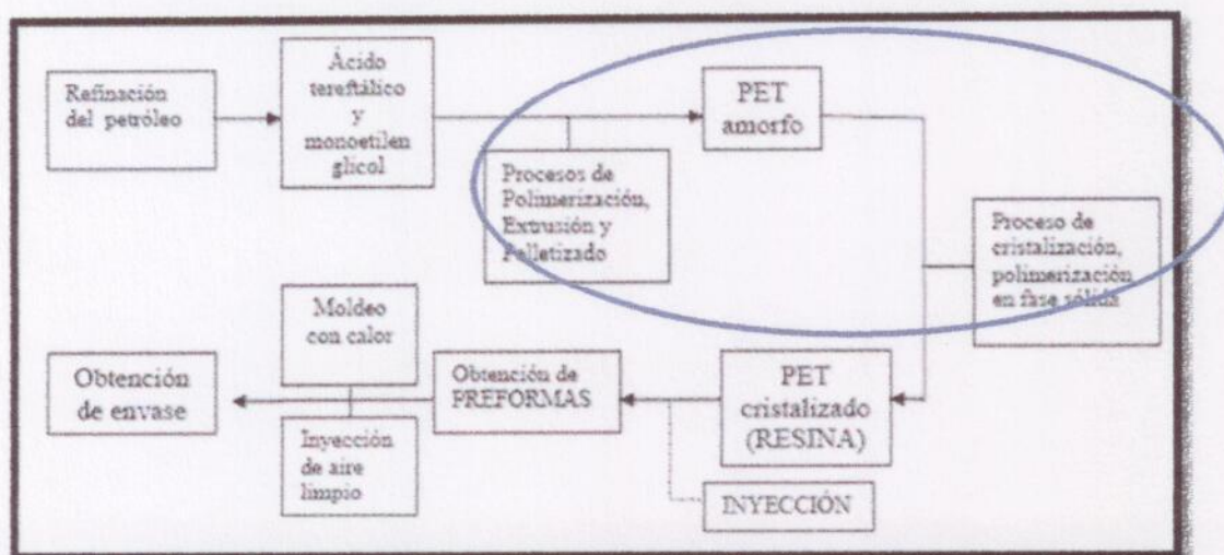
Ilustración 28. Industria Petroquímica. Polo Petroquímico Campana-Zárate – San Nicolás. DAK AMERICAS Argentina S.A. Diagrama de Flujo Integral de envases a partir de PET
