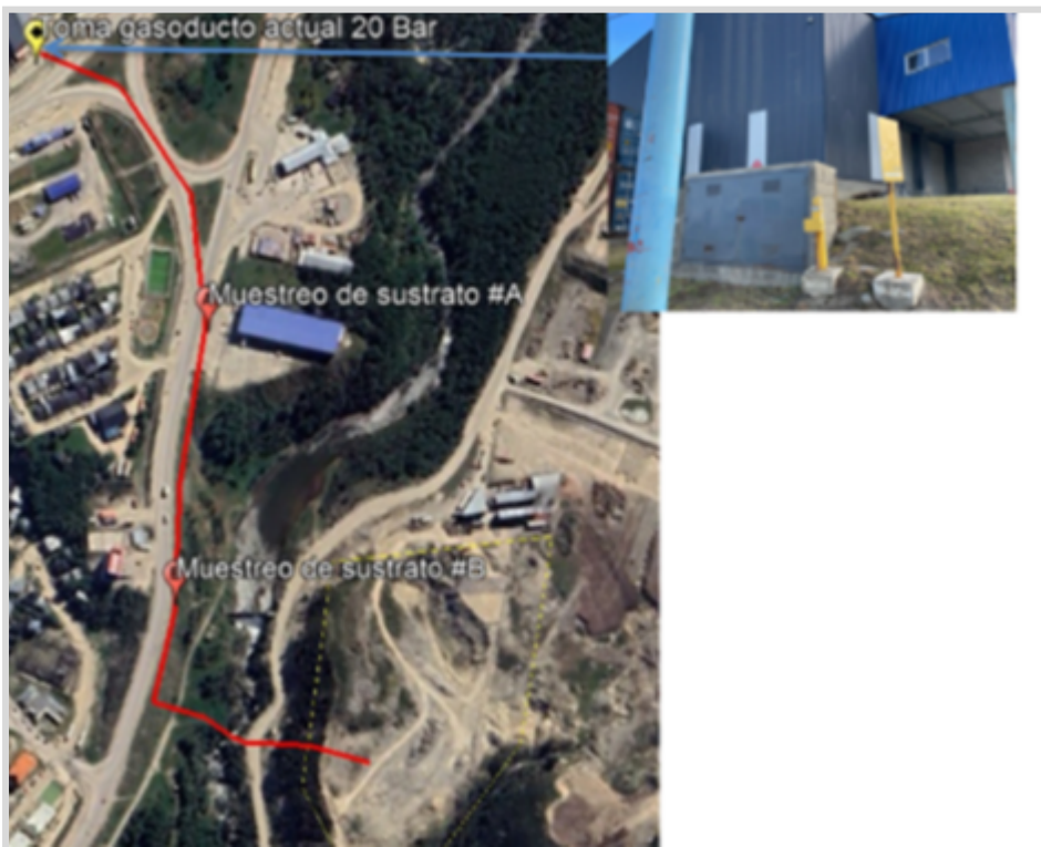
Imagen 4 -Traza propuesta para el gasoducto de alimentación para la nueva Central Termoeléctrica con el gasoducto principal de Camuzzi.
