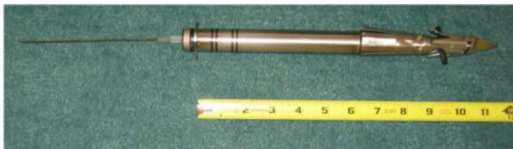
Figura 34. Transmisor satelital – Sistema Argos (medidas en pulgadas)
