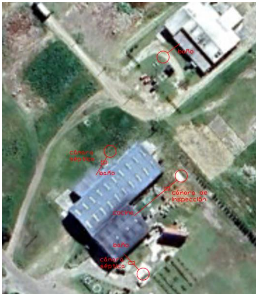
Figura 6: croquis general de conducciones – En el Parque Industrial existen un total de 4 pozos absorbentes, con sus respectivas cámaras sépticas. La distancia entre cada uno de ellos y los pozos de explotación supera los 15 metros, favoreciendo así la no contaminación subterránea.
