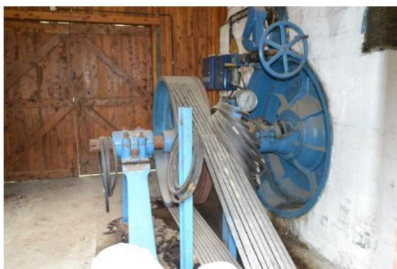
Figura 4.32. Turbina hidráulica Francis de cámara abierta. Fuente: Secretaría de Energía de Río Negro e INVAP Ingeniería S.A.
