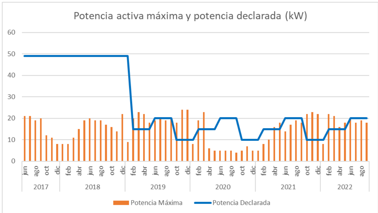
Figura 61: Potencia Activa máxima y potencia demandada (kW) - CET N°21
