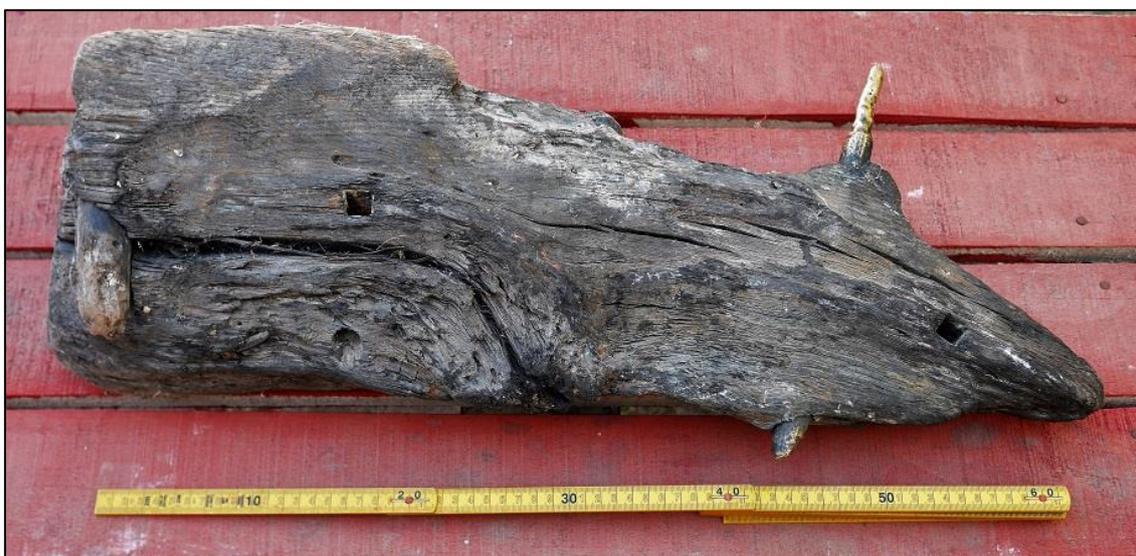
Figura 14: Fragmento de madero estructural con perno y cabillas
