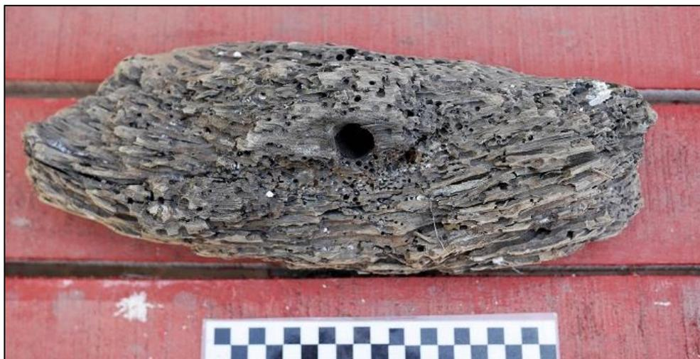
Figura 17: Restos madera con ataque de perforantes
