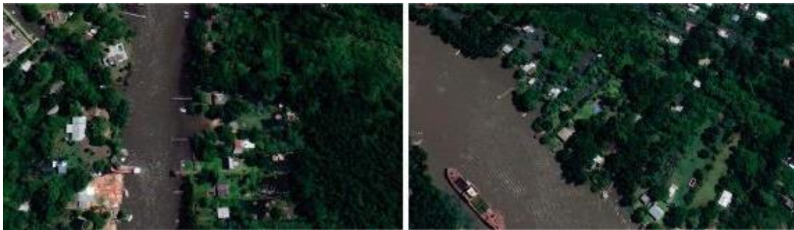
Figura 8: Costas de canales muy urbanizados con los bordes aserrados producidos por la erosión y/o estabilización a través de diferentes protecciones
