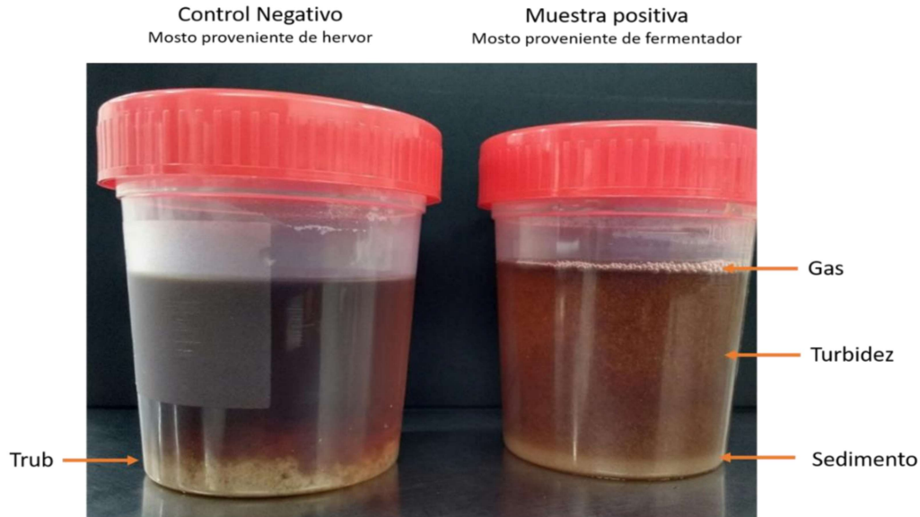
Imagen 5. Test de mosto forzado positivo (derecha) detectado por la presencia de gas, turbidez y sedimentos en comparación con su control negativo (izquierda) en la que sólo se observa la presencia de proteínas coaguladas (trub).
