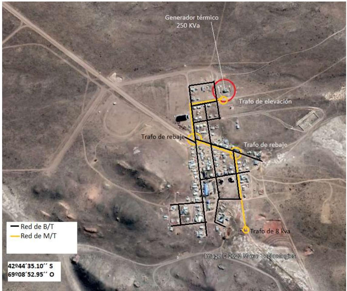
Figura n°20. Detalle de redes de M/T y B/T.
