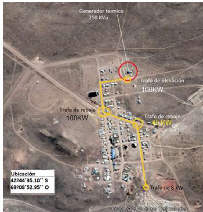
Figura n°5. Vista general de la Comuna con la red de 13,2KV y los transformadores.
