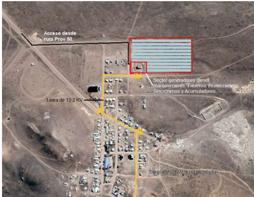
Figura n°30. Layout con superficie a ocupar por paneles para alternativa de 30% generación térmica.
