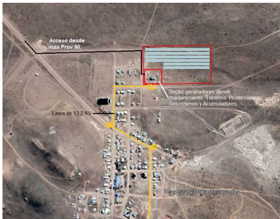
Figura n°27. Layout con superficie a ocupar por paneles para alternativa de 60% generación térmica.
