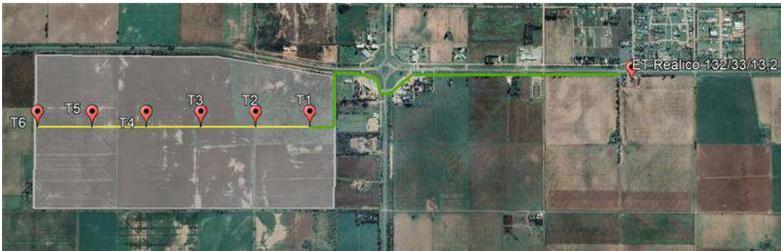
Ilustración 62 – Layout parque eólico Realicó 25,2 MW p
