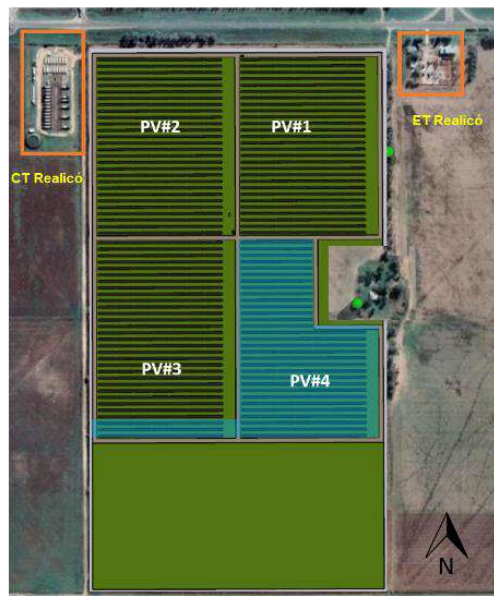
Ilustración 38 – Layout parque solar fotovoltaico Realicó 24 MW p
