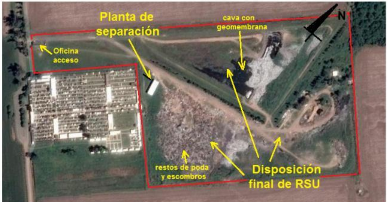
Imagen Google Earth: detalles del Predio de disposición final y Planta de RSU
