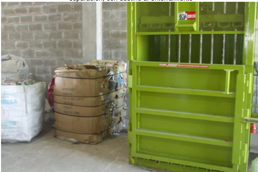
Foto nº 23: Vista interior de máquina de prensa y armado de fardos y primer fardo elaborado
