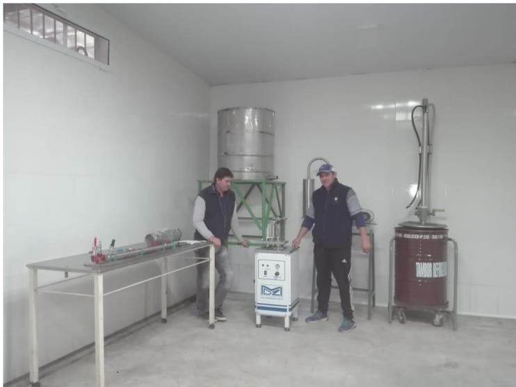
La línea de fraccionado es semiautomática, compuesta por jirafa derretidora de miel, filtro, bomba de elevación, tanque decantador pequeño, y dosificadora semiautomática, mesadas de acero inoxidable y carro de acero inoxidable para la extracción de los frascos tapados hacia sala de etiquetado y empaçado.
