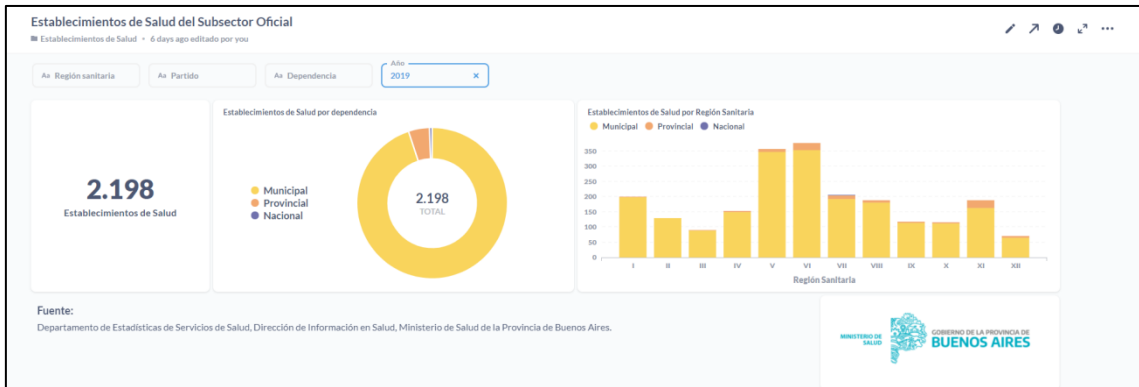
Imagen 9: Tablero de Establecimientos de Salud del Subsector Oficial , obtenido desde el Metabase reflejando los indicadores y las modificaciones desarrolladas en esta etapa. El panel presenta datos para la serie 2017-2020 y es alimentado desde la base de datos desarrollada en PgAdmin (PostgreSQL) con la información provista por el Departamento de Estadísticas Vitales. Fuente: Elaboración propia.
