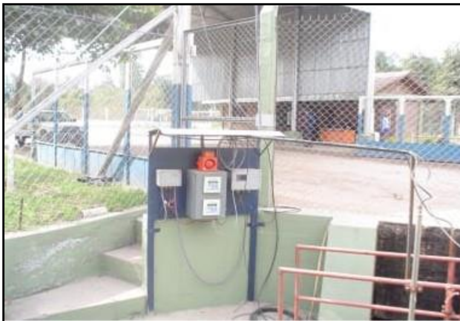
Figura 19.: Estación de control de calidad en aguas de riego con efluentes (Imagen propiedad del autor)
