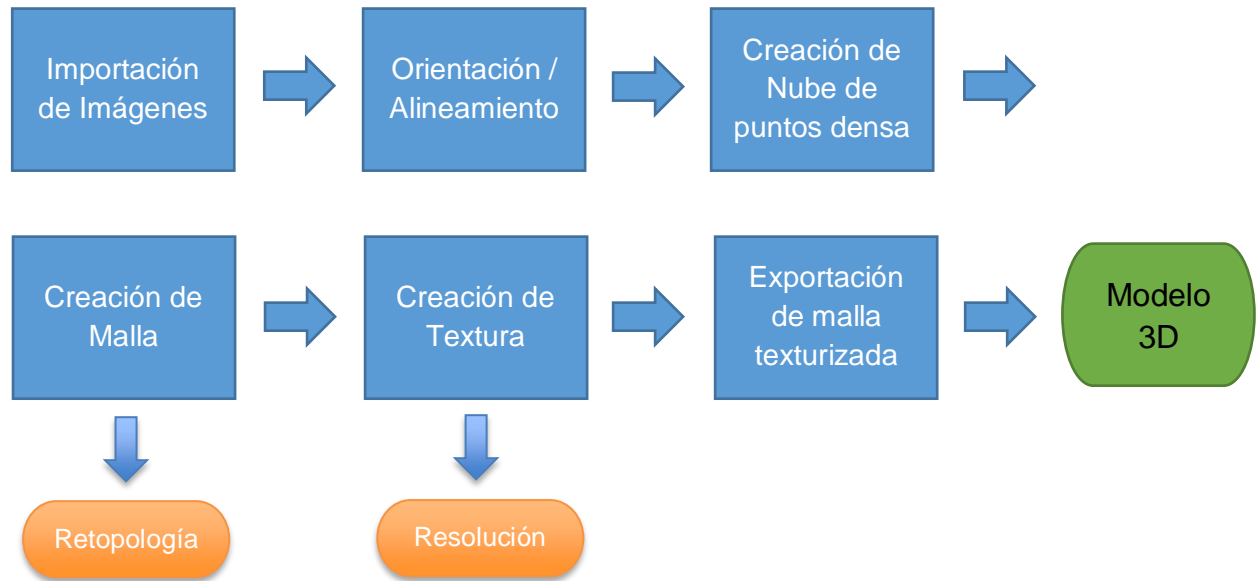
Fig.7: Flujo fotogramétrico con aplic. de filtros para reducir el peso de los modelos 3D
