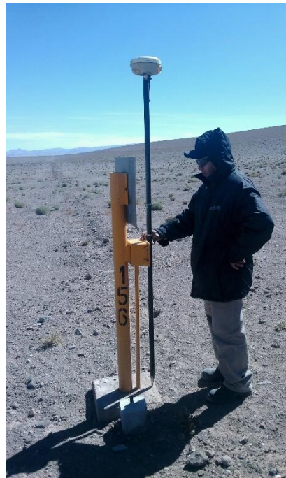
IMAGEN 15. RELEVAMIENTO PUNTO FIJO MOJON. FOTOGRAFIA IMG6_101504.JGP.
