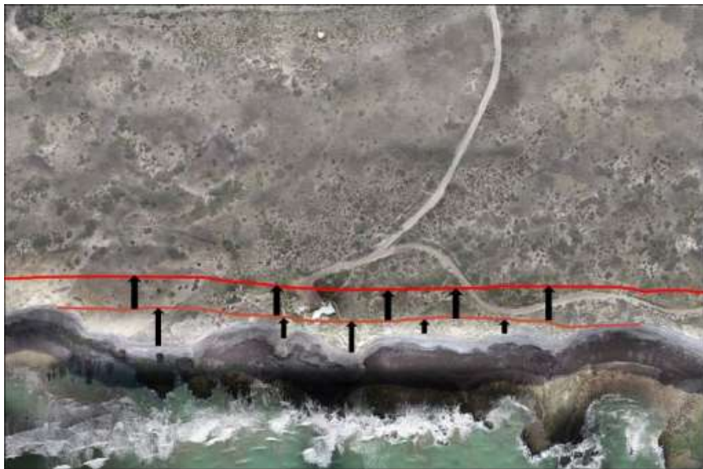
Figura 5.16: Estimación de la rectificación de la línea de cresta, en primera instancia a la línea naranja y posteriormente la roja. La longitud de las flechas indica cualitativamente la intensidad de erosión.
