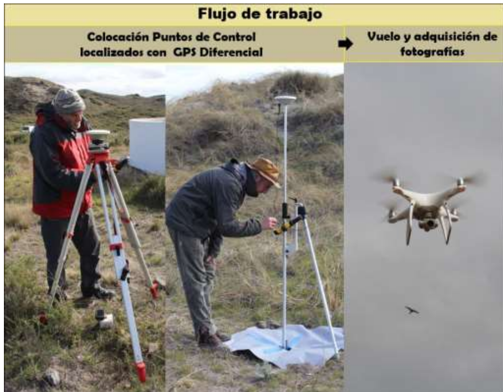
Figura 5.10: Metodología de trabajo para la adquisición de ortomosaicos rectificadas y modelos digitales de elevación.
