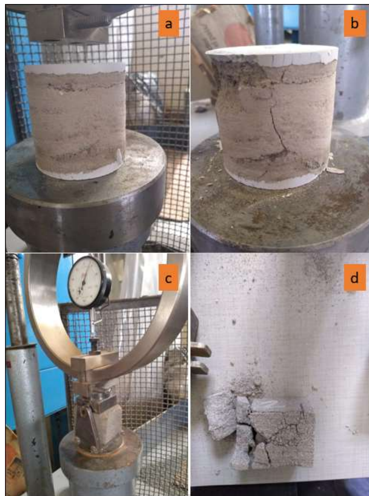
Figura 4.2: (a) Prensa de compresión simple; (b) Rotura de probeta circular ;(c) Muestra cubica en Prensa de compresión simple; (d) Muestra rotura de probeta cubica
