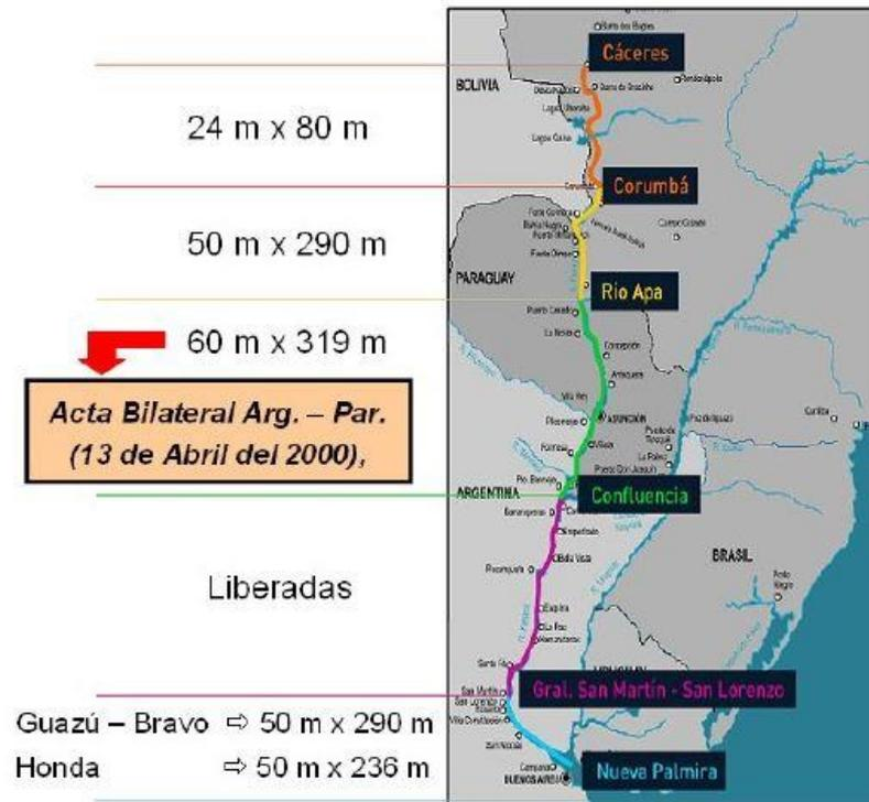
Figura 2.3.5.d Tipos de Trenes de Barcazas Permitidos por sección de la HPP
