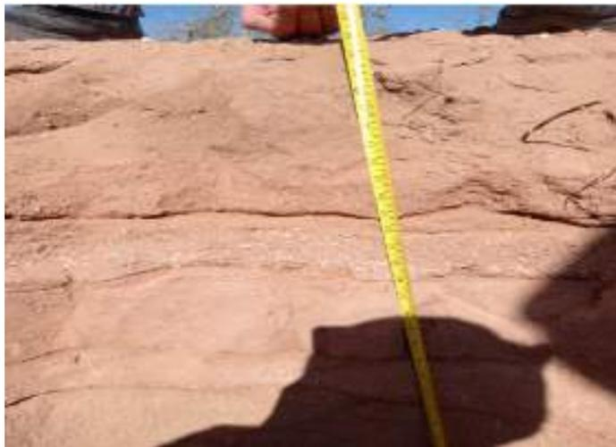
Imagen 13, 14 y 15: calicata 2 de 1,70 m de profundidad, con capas diferenciadas y presencia de piedras al final.
