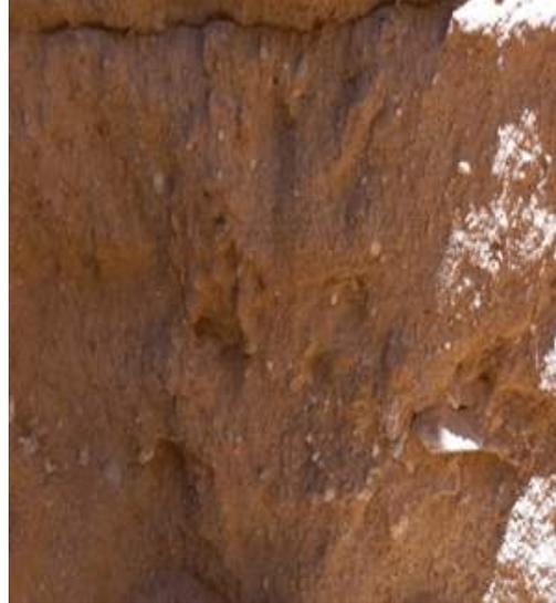
Imagen 18, 19, 20, 21: calicata 3 de 1,70 m de profundidad, con capas diferenciadas y presencia de piedras al final.
