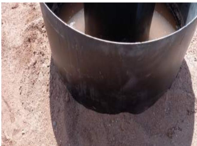
Imagen 22: ensayo de infiltración 3 en el entorno a la calicata 3.
