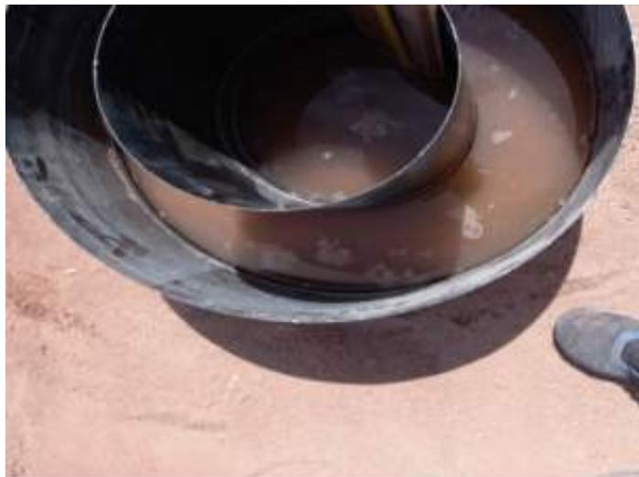
Imagen 16: ensayo de infiltración 2 en el entorno a la calicata 2.
