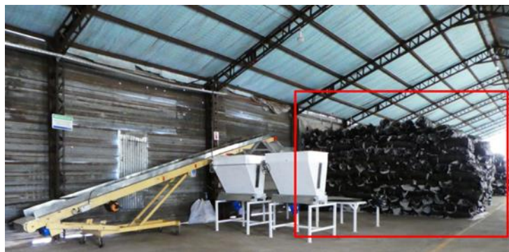
Figura 9. Mantas oliofílicas (en recuadro rojo) y parte de la maquinaria utilizada para su producción.
