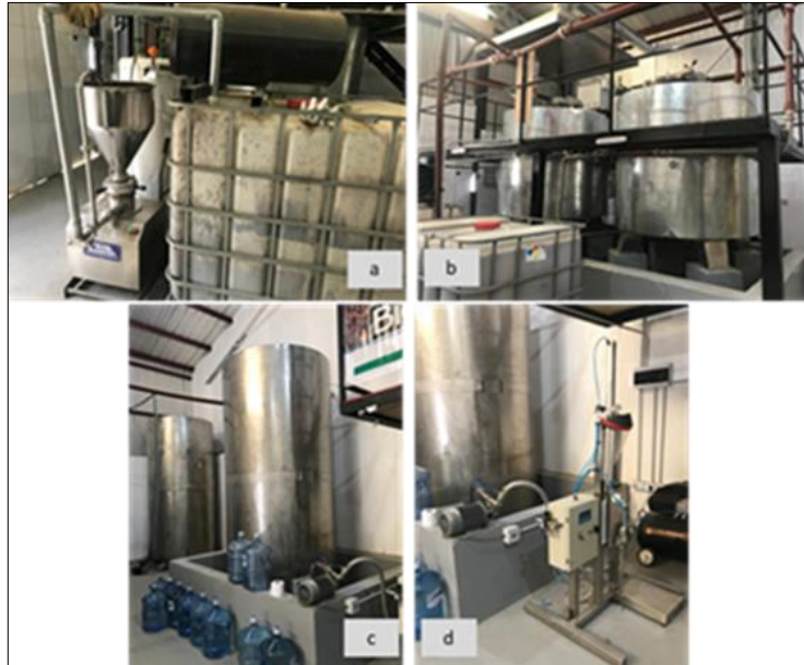
Figura 8. Maquinaria para producir enmienda líquida (a. Molino microlizador; b. digestores; c. buffers estacionarios; d. envasadora).
