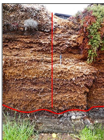
Figura 14. Perfil de corte en zanjas con extracción de bloques (entre 1,5 y 2 m de profundidad). El cambio de color del material indica la capa superior viva y la inferior de turba negra.
