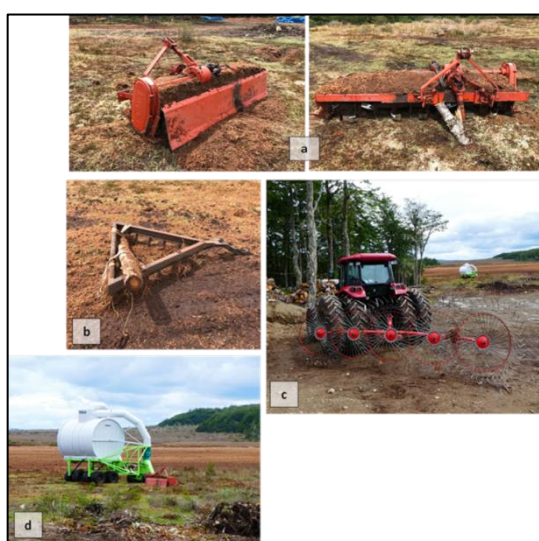
Figura 12. a. Retrobatedora con la que trituran la turba. b. Rastrillo que va agarrado al cuatriciclo. c. Rastrillo que pasan al final del proceso antes de aspirar la turba, en el fondo de la imagen se observa la aspiradora. d. Aspiradora.
