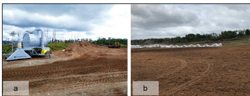
Figura 11. Extracción de turba método superficial. a. Equipos trabajando en la turbera. A la izquierda de la fotografía la aspiradora y a la derecha la cargadora. b. Las bolsas blancas cumplen la función de proteger a la turbera del viento.
