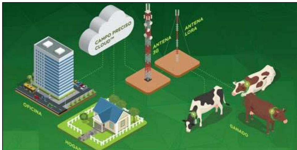
Imagen 6. Esquema de comunicación para el sistema MuSensor. [Fuente: zonacampo.com.ar]
