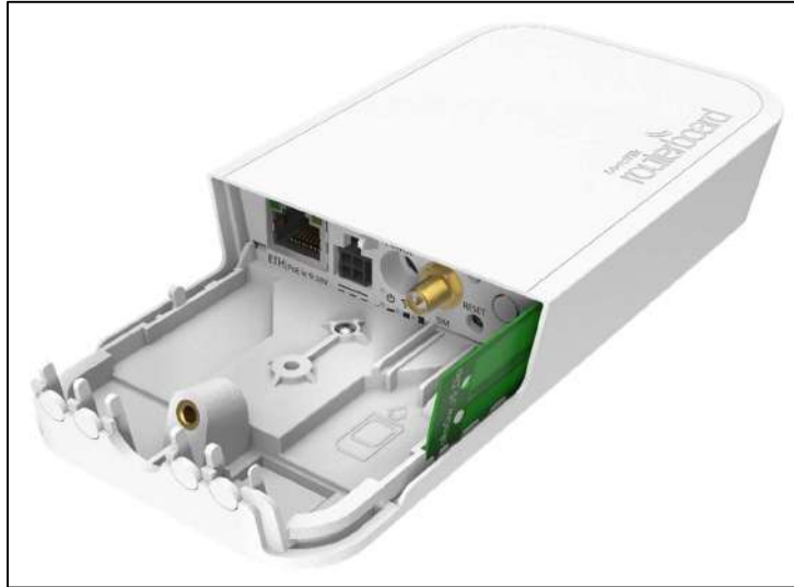
Imagen 13. Gateway Lora Mikrotik wAP LR9. [Fuente: elaboración propia]
