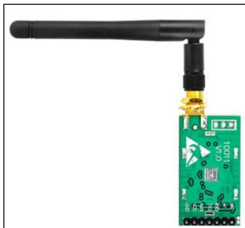
Imagen 10. Módulo de Comunicaciones LoRa Gowoops con SX1276 [Fuente: elaboración propia]
