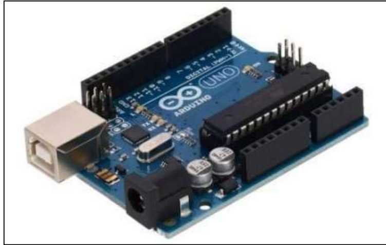
Imagen 12. Módulo de Microcontrolador Arduino UNO. [Fuente: elaboración propia]
