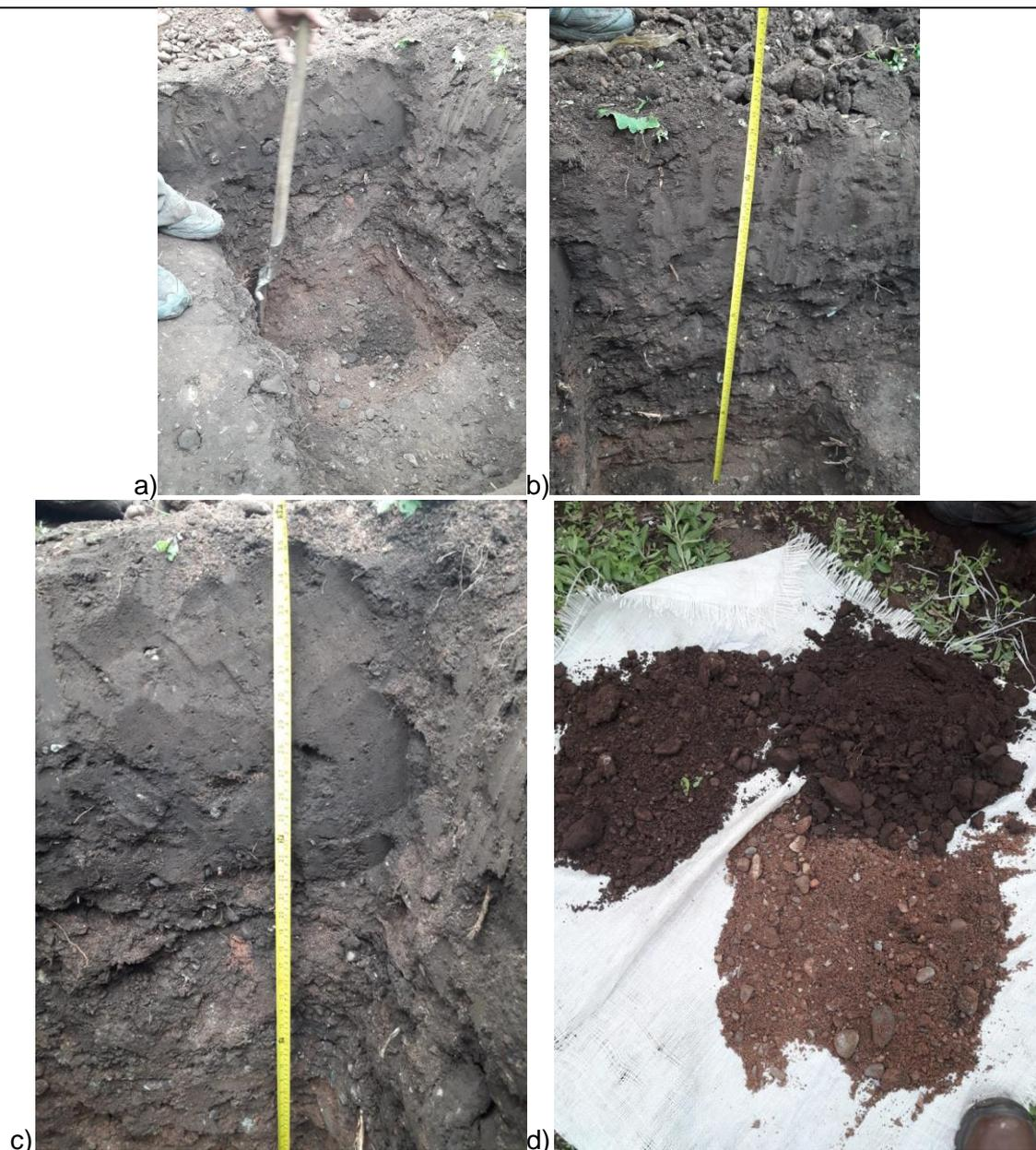
Foto : a) y b) Excavación de calicata N°2; c) horizontes; d) extracción de muestra de suelo.
