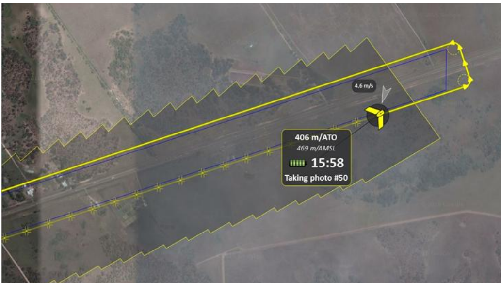
Cobertura de fotografías del Dron en línea de vuelo
