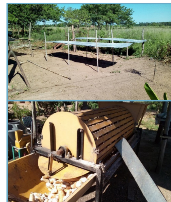
Figura N°62: Picadora de Mandioca -San Miguel -Secado del almidón- Paraje Cerrito Corrientes.
