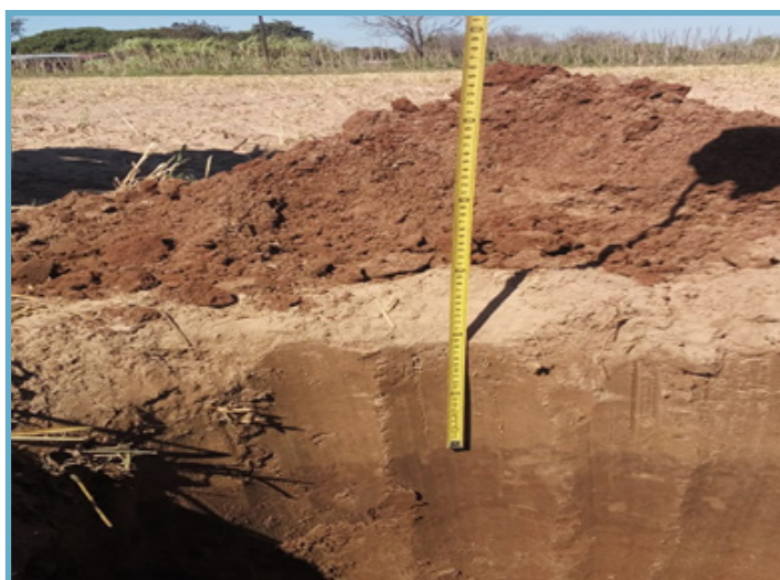
Figura N°16: Calicata realizada por el equipo técnico.
