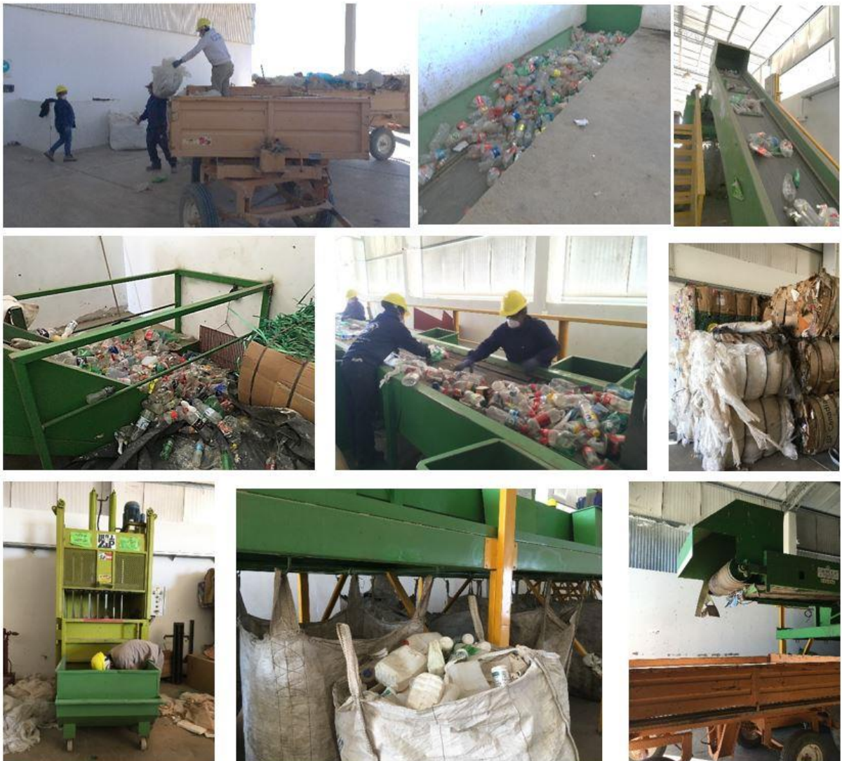
Fig. 79: Etapas del proceso de clasificación de residuos en la ecoplanta
