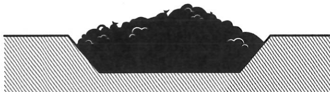
relleno de trinchera
