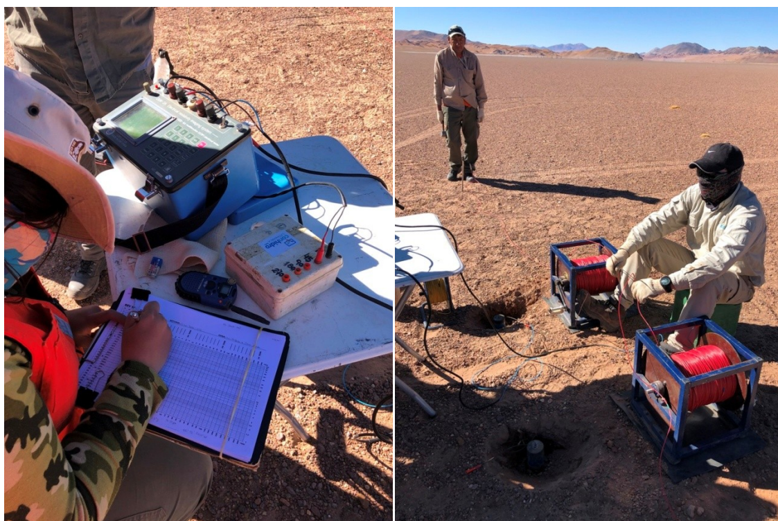
Foto 22: Equipo resistivímetro (izq.) y carretes de cable de corriente (der.).
