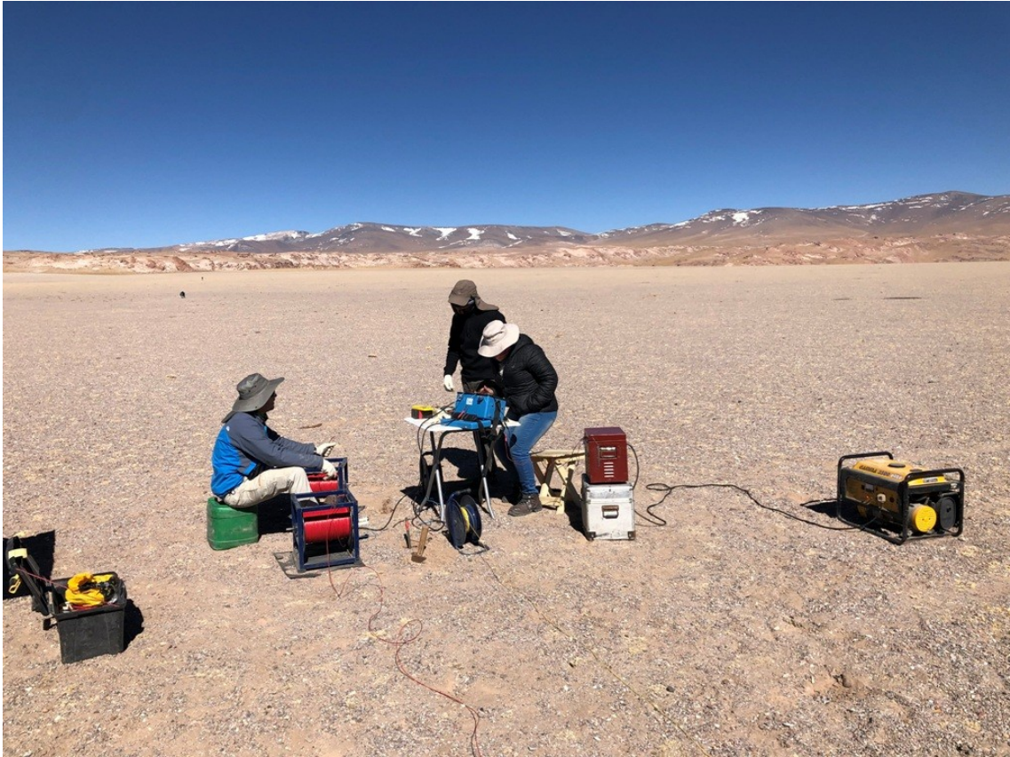
Foto 23: Equipo resistímetro, grupo electrógeno y convertidor de corriente.
