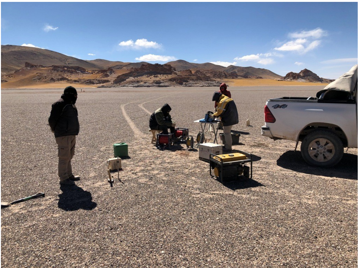
Foto 26: Realización de un SEV próximo a perforación proyecto Candelas.
