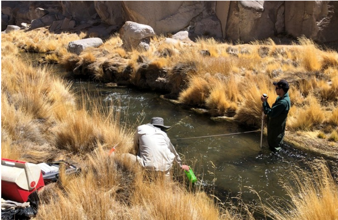
Foto 17: Aforo (A2) en Río Aguas Calientes.
