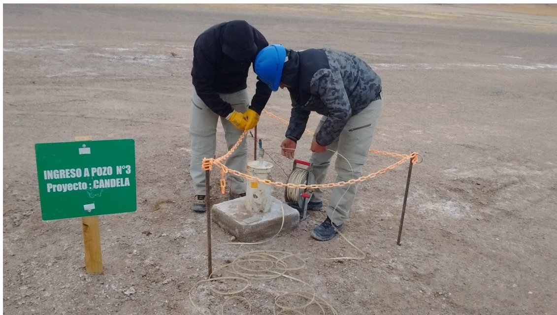
Foto 16: medición de nivel estático durante el censo de perforaciones.
