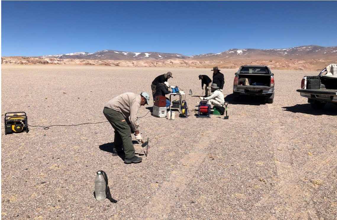
Foto 25: Instalación de electrodos en dispositivo tertapolar Schlumberger.
