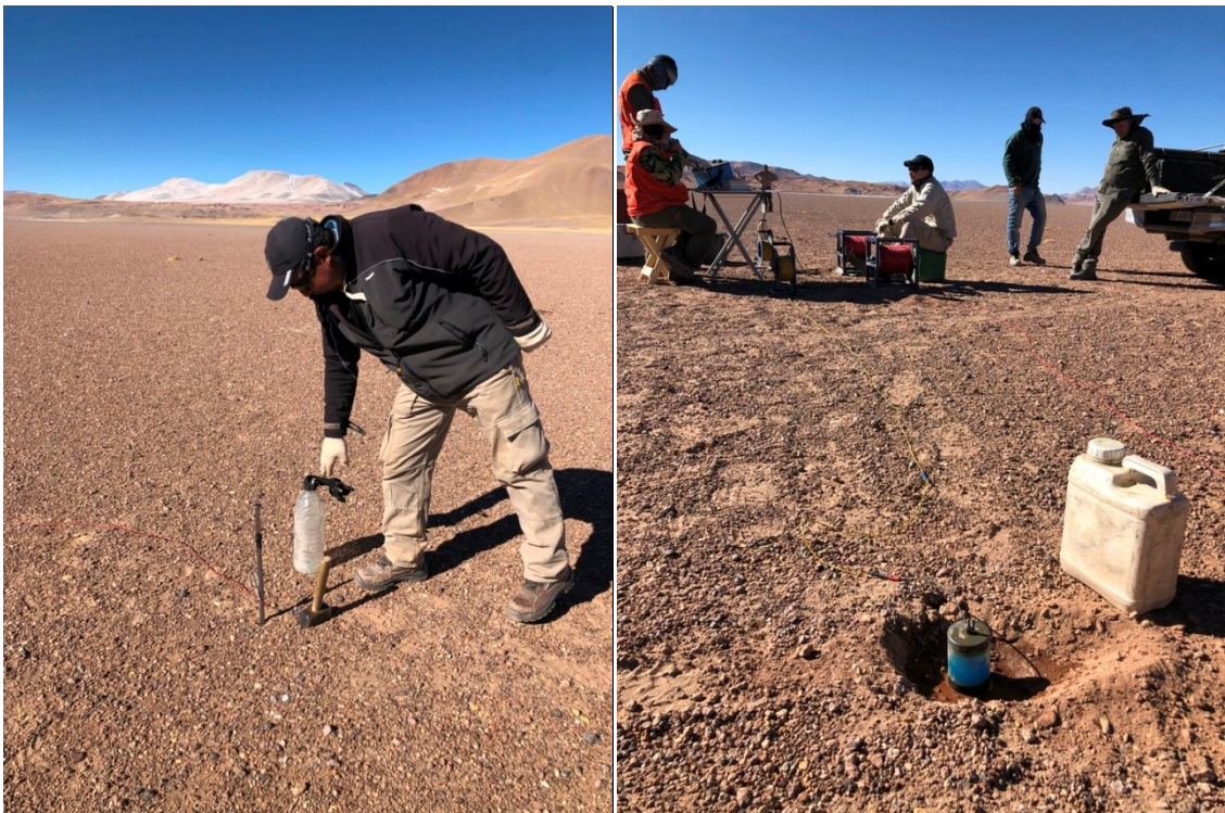
Foto 24: Electrodo de corriente (izq.) y electrodo de potencial (der.).
