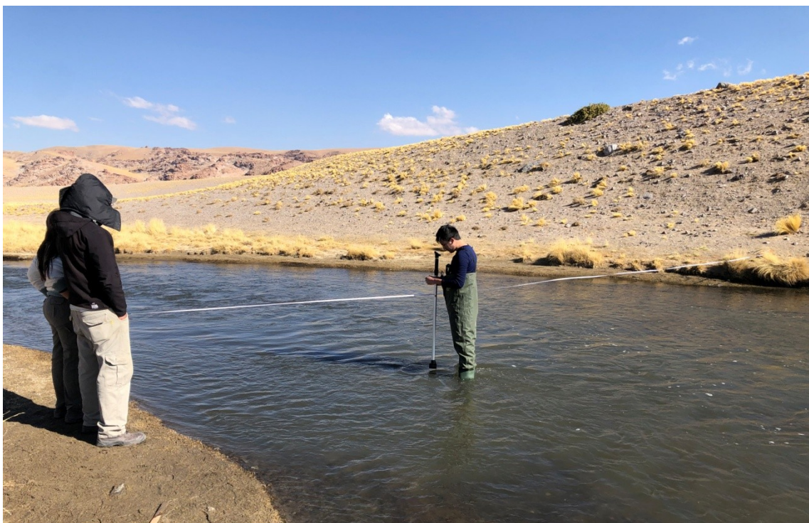
Foto 18: Aforo (A1) en Río Los Patos.
