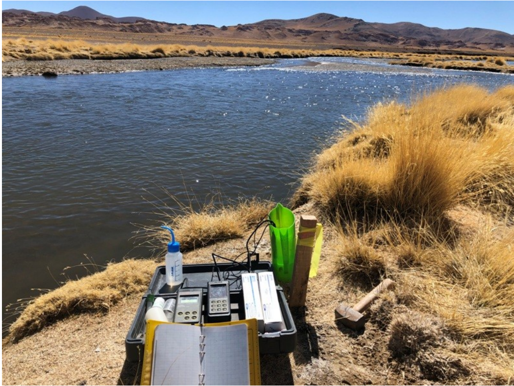
Foto 20: Medición de parámetros físico-químicos del agua.
