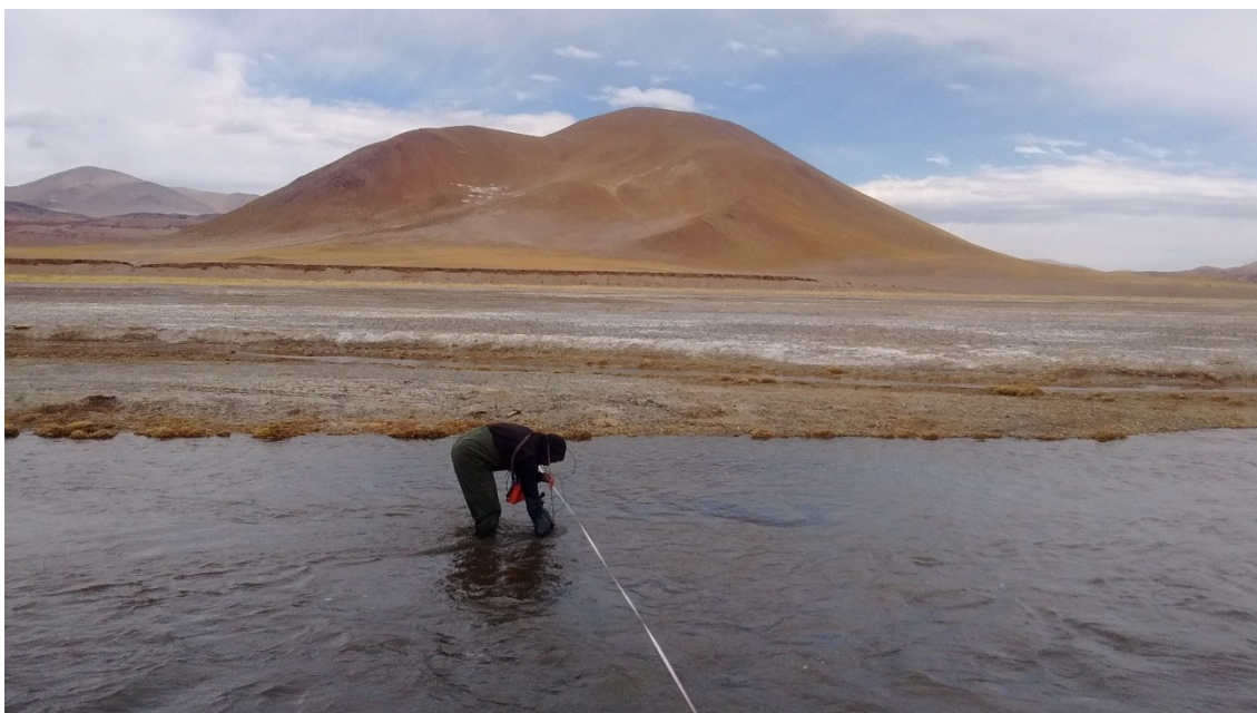
Foto 19: Aforo (A3) en Río Los Patos, zona batería pozos Livent.
