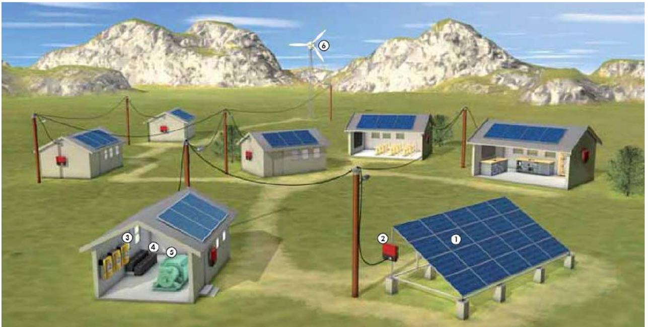
Ilustración 16: Ejemplo de micro-red híbrida típica
