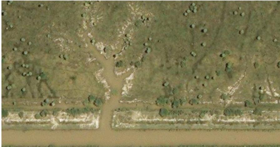
**Figura N° IV.16** Erosión margen izquierda canal Línea Paraná – Tramo II
