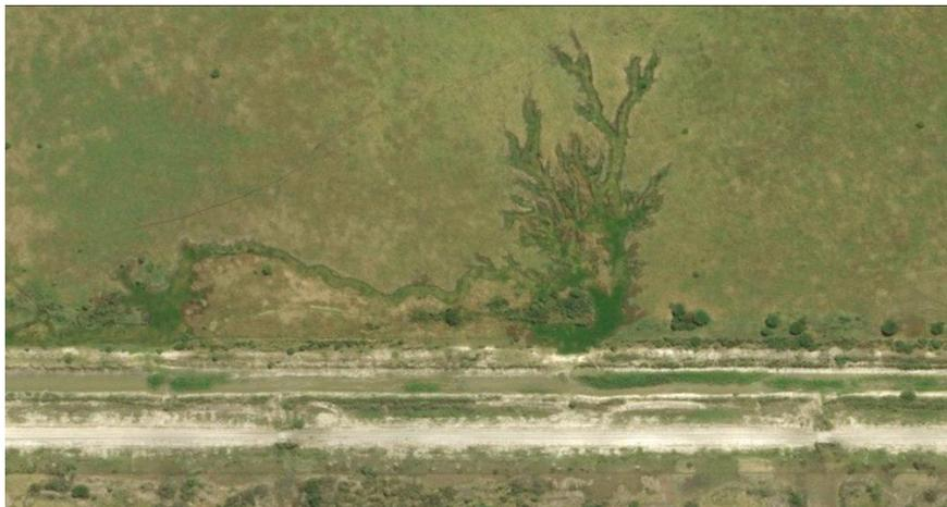
**Figura N° IV.17** Erosión margen izquierda canal Línea Paraná – Tramo III-1
