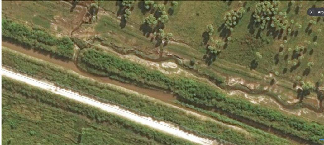
**Figura N° IV.18** Erosión margen izquierda canal Línea Paraná – Tramo III-1
