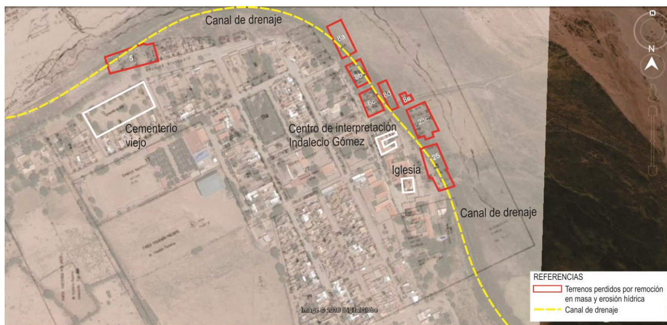
Fig. 48: Superposición de un plano de 1979 (indicando las manzanas en el área urbana) con una imagen satelital actual. El ascenso de la napa y la erosión de ríos torrenciales en la margen del área urbana -colindante con el actual canal de drenaje-, han llevado a la pérdida de una gran porción de tierras edificadas, incluidas las manzanas delimitadas en rojo.
