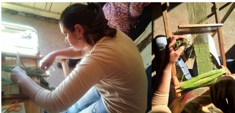
Vieron como cortar urdimbre, como colocar en el telar, enroscar a los rollos, nudo peruano, colocar los hilos de la trama en la naveta y comenzar a tejer, bordes prolijos, cambio de hilo si se termina.
