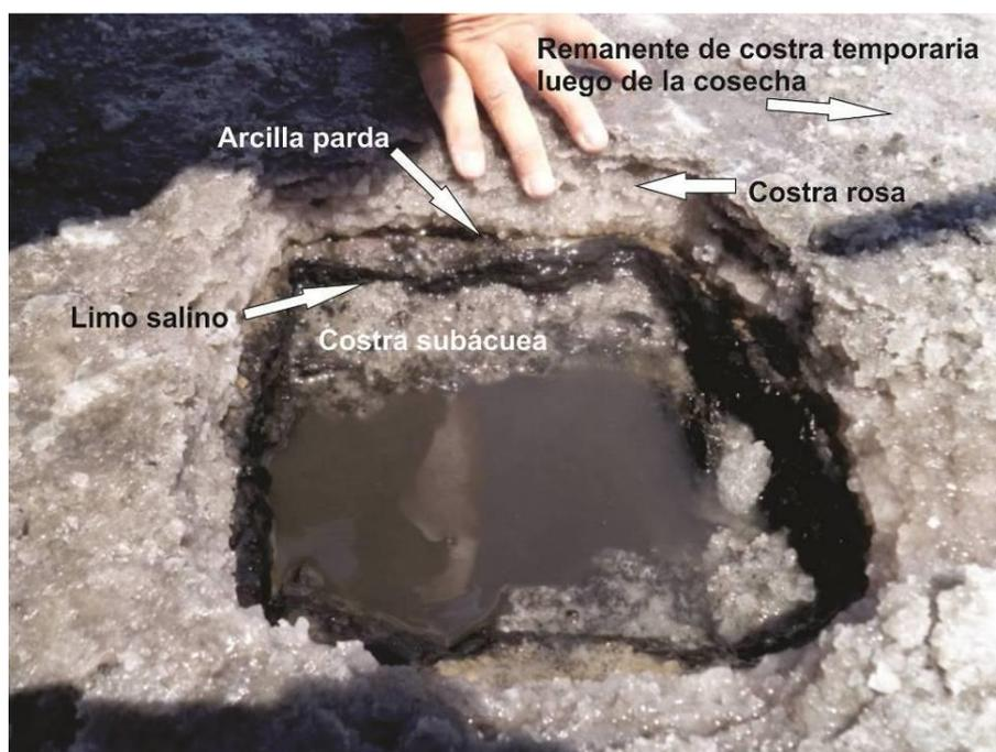
Figura 247. Salina Anzoátegui, pozo M2-19, detalle de los distintos estratos.
