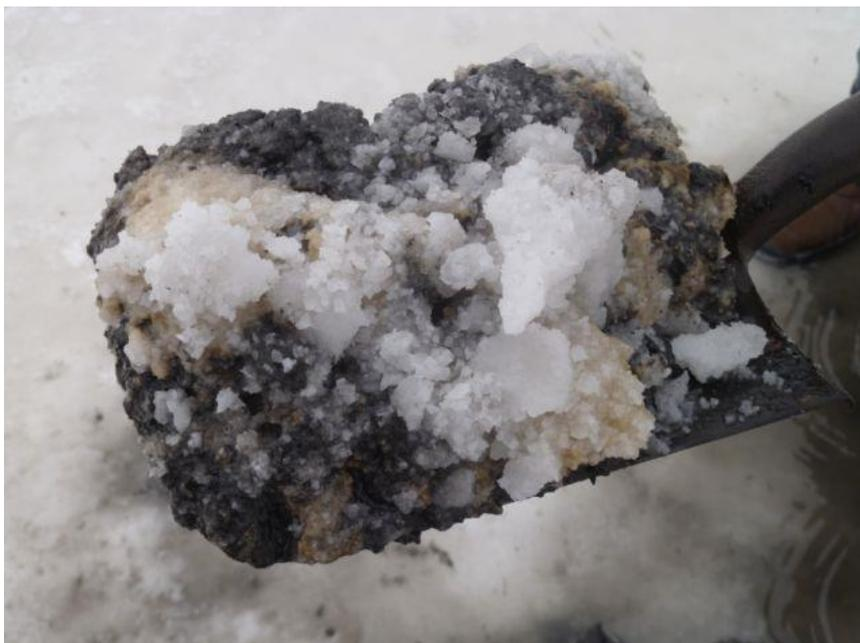
Figura 38. Salitral La Salinilla, zona con costra superficial, materiales extraídos del pozo en el interior del salitral totalmente saturados en salmuera.
