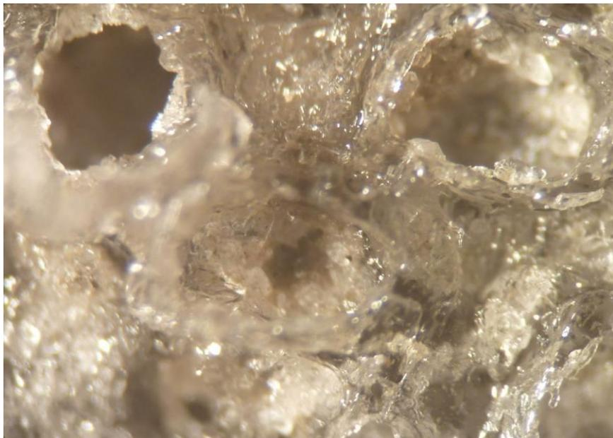
Figura 142. Salina San Máximo, vista con lupa binocular de la costra soldada (base de la imagen 0,4 cm).
