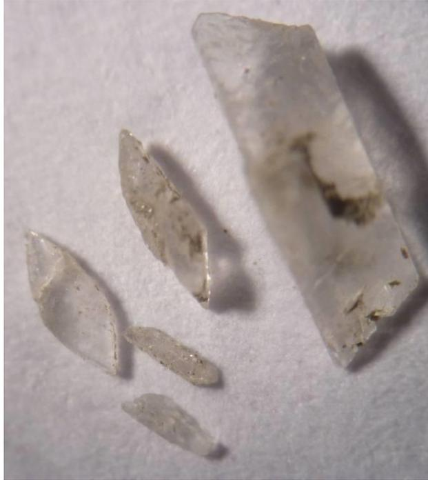
Figura 219. Salina Salitral Negro, fragmentos de cristales de yeso prismáticos, imagen de lupa binocular (base de la imagen 0,6 cm).
