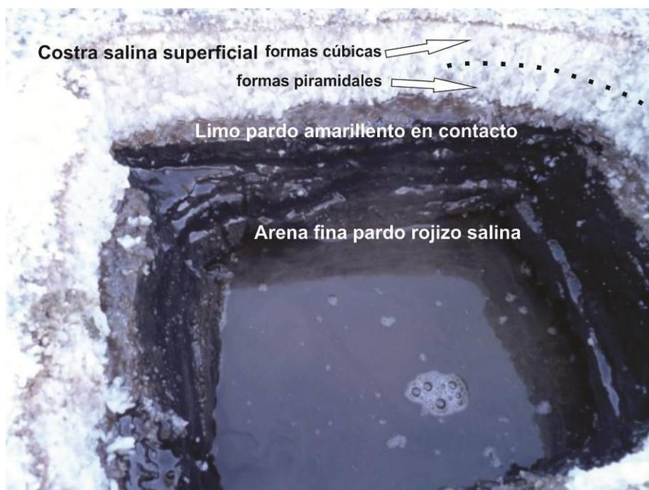
Figura 204. Salina Pichi Norte, pozo cavado en la salina.
