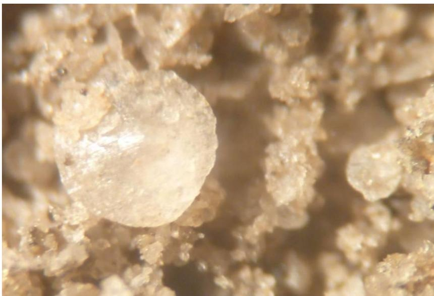
Figura 183. Salina Pichi Sur, yeso discoidal a la lupa binocular, (base de la imagen 0,22 cm) en fig. 186 imagen al microscopio electrónico.
