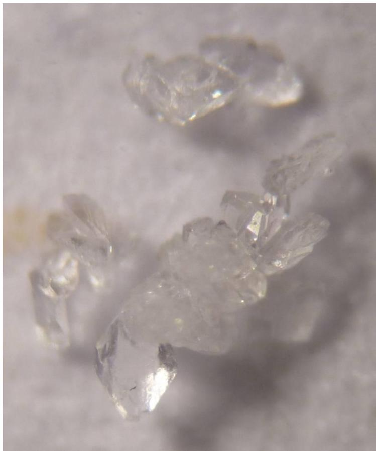
Figura 36. Salitral La Salinilla, cristales de bloedita-astracanita ( $\text{Na}_2\text{Mg}(\text{SO}_4)_2 \cdot 4\text{H}_2\text{O}$ ), hábito en rosetas, intercaladas entre la halita en la costra superficial, imagen de lupa binocular, (base de la imagen 0,3 cm).
