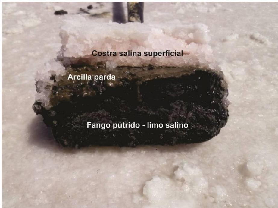
Figura 248. Salina Anzoátegui, material retirado de los primeros centímetros del pozo M3-19.
