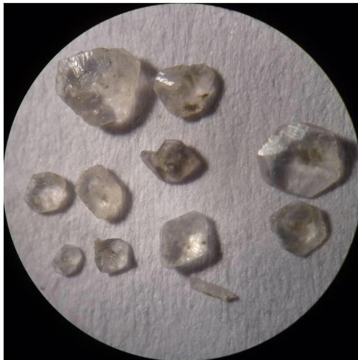
Figura 218. Salina Salitral Negro, cristales de yeso con diferentes hábitos, imagen de lupa binocular, (diámetro de la imagen 1 cm), en figuras 220, 220-1 y 221, observación al microscopio electrónico .
