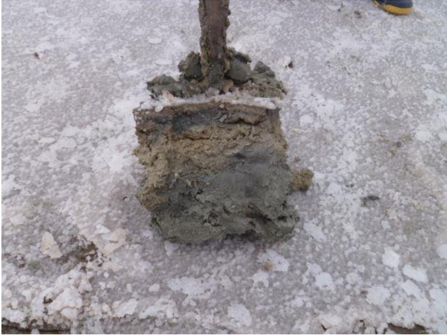
Figura 63. Salina Grande, material extraído del pozo hasta los 20 cm de profundidad.
