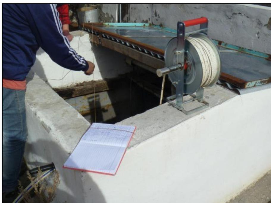
Foto 15. Toma de muestra en pozo construido N°P120.
