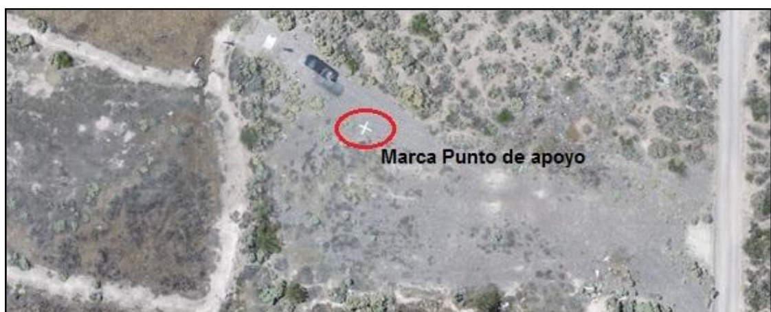
Figura 36: Imagen obtenida con el dron, se observa la marca del punto fijo.
