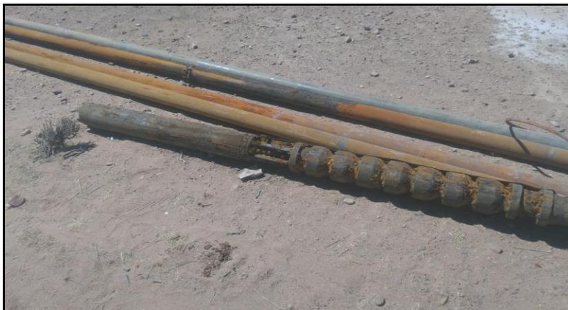
Bomba Electrosumergible y cañería extraída del Pozo.
